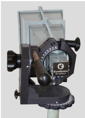
Фото 1. На примере антенны П6-124 на диэлектрическом штативе (ШАД-01)
